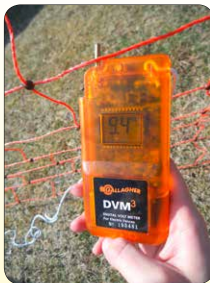
V mreži morajo biti vedno prisotni električni pulzi jakosti vsaj 5 Kv. (Foto: Rok Černe)
